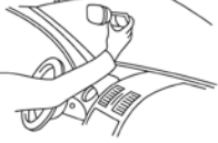
OGS cihazınızı, aşağıda yer alan "Önemli Not" kısmındaki açıklamaları dikkate alarak, tutucunun yerleştirildiği yüz araç camına bakacak şekilde araç camına takın. OGS cihazınızı monte edeceğinizi yeri belirleyin. Cihazın, dikiz aynanızın arkasında görüşünüzü engellemeyecek bir noktada olacağından emin olun.
