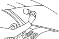
OGS cihazınızı, belirlediğiniz alana, dik olarak, dikkatli biçimde yapıştırın ve en az 10 saniye boyunca bastırarak tutun. Yapıştırdıktan sonra 24 saat süreyle cihazınızı yerinden oynatmayın.
